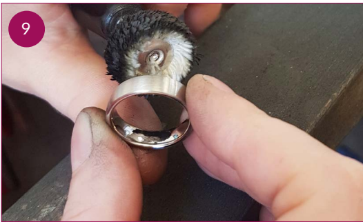
Mit einem Polierrädchen und unterschiedlichen Polierpasten wird der Ring bearbeitet , um ihn zum glänzen zu bringen.
