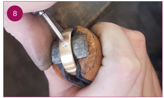
Mit dem Stahl des Einreibers wird das umliegende Material über den Stein gedrückt und dieser somit fest fixiert.
