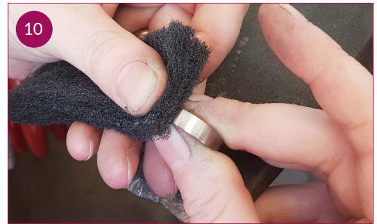
Die gewünschte Oberfläche , hier zum Beispiel ein Längsmatt wird als Finish von Hand aufgebracht.
